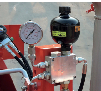
Alleggeritore idraulico della testata
