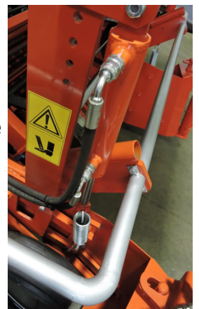
Rullo "sotto testata" a sostegno della testata di raccolta
