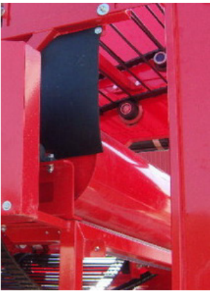
Rullo posteriore sul nastro trasversale per l'eliminazione dello scarto
